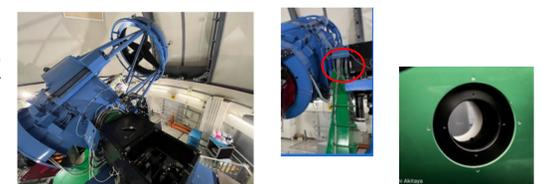
図11: かなた望遠鏡第二ナスミス焦点と既存のBK7光学窓
