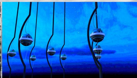
氷河の下およそ1立方kmの範囲に、球型の検出器5160個を埋設し、素粒子ニュートリノを測定しています。目に見えず、なんでも通り抜けてしまうニュートリノを直接捉えることはできないので、氷と衝突した時に生成する荷電粒子が出す微弱な光「チェレンコフ光」を検出しています。
