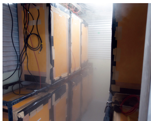
図2: -40^{\circ}\text{C} の温度を保った冷凍庫。内部にはD-Eggを入れる箱が設置してある。
