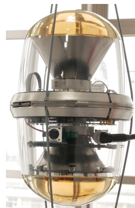
図1: (左)筒状ガラスの上下に上向きと下向きのPMTを容れこむことでより細くすることを可能にした初期のデザイン。結局このようなデザインでは製作が難しいことがわかる。(右)実際に製造されたD-Egg
