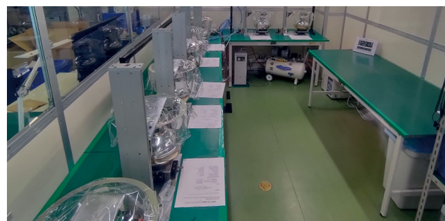
図2:NME福浦整備場内のクリーンブース。写真左側に光学ゲル硬化待ちのD-Egg半球が並んでいる。作業机には静電防止シート (緑) が敷かれている。
