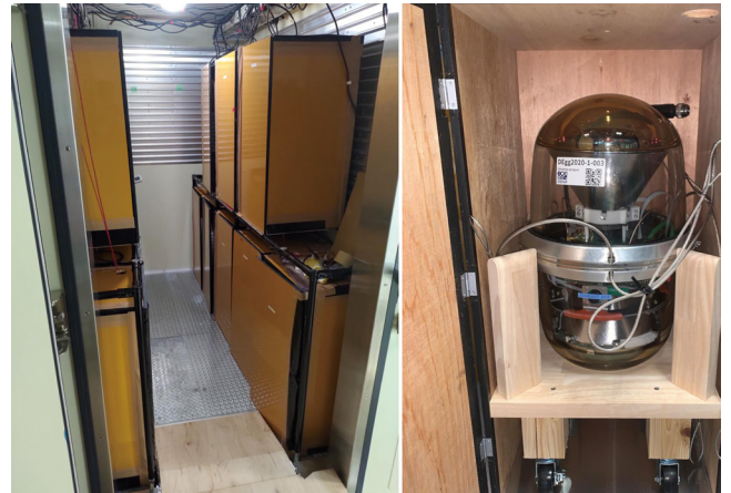
図5:(左)本研究室所有の大型フリーザー及びD-Egg収納用の暗箱。(右)暗箱内へ収納された状態のD-Egg。
