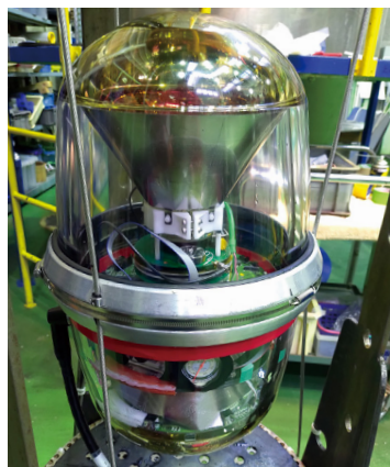
図1:千葉大学が開発した卵型光検出器D-Egg。写真は海洋研究開発機構の高圧実験水槽装置を用いた耐圧試験時のもの。
