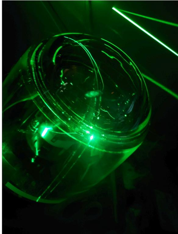
図 5.8: ファインメットとゲルの中に光を入射させたときの写真. ゲルやガラスでの反射を繰り返し, PMT に光が届いているのがわかる.
