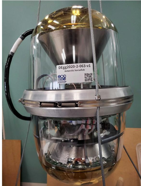
図 3.1: 2023 年, 南極に 300 台埋設予定の新型光検出器 D-Egg. 上下に 2 つの PMT が搭載されており, 他にも較正装置であるカメラや LED 基板が搭載されている.
