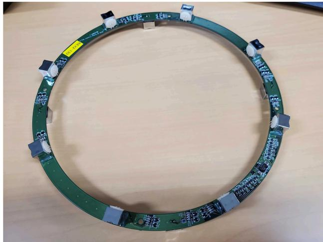
図 3.8: 較正用 LED 基板. ドーナツ型をしていて水平向きに 45 度間隔で 8 個, 鉛直下向きに 90 度間隔で 4 個の LED を搭載している.
