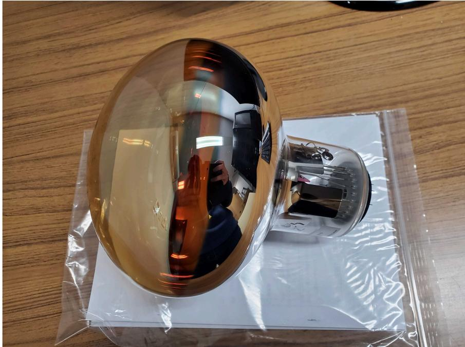
図 3.3: D-Egg に採用されている PMT(R5912-100).8 インチで光電面はバイアルカリでできている.
