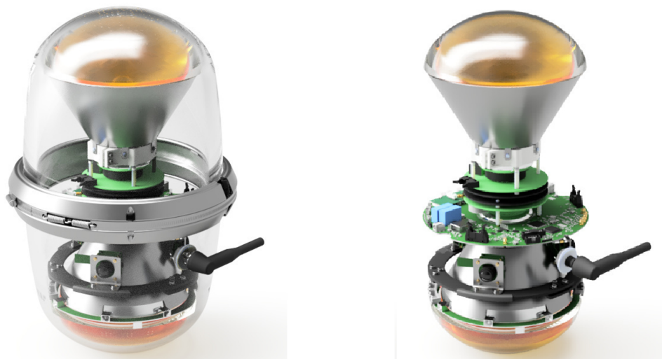
図 2.6: D-Egg の外観図と内部構造図。卵型のガラス容器の中に、上下に PMT が設置されている。2 台の PMT の中央には、データ収集基板 (DAQ 基板) があり、その上には 2 枚の高電圧基板がある。ガラス容器からペネトレータケーブルが出ている。下側の PMT の周囲には、カメラと、LED が配置された Flasher ring が設置されている。
