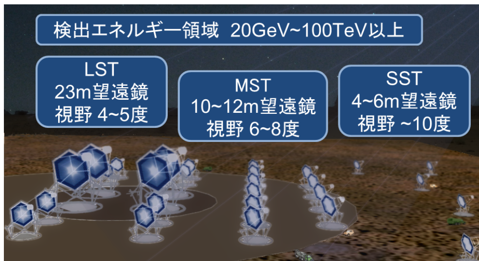
図 2.2 CTA 計画の望遠鏡配置 [2]。(右上) 北サイトおよび(右下) 南サイトの完成予想図。
