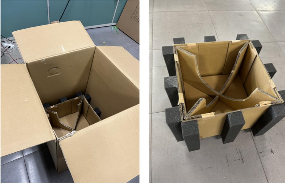
図 A.4: 右: 輸送用のダンボール箱。左: ダンボール内で G2DOM の上下に入れる緩衝材付きの台座。
