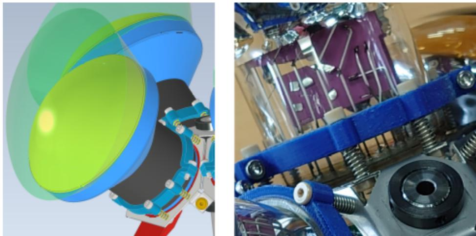
図 3.12: 右: バネによる押し出し構造の 3 次元図面。左: バネ部分の写真。 [11]
