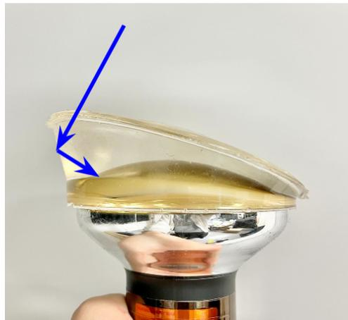
図 3.3: 全反射による光の経路。ゲルパッド側面で光子が全反射することを利用するデザインである。
