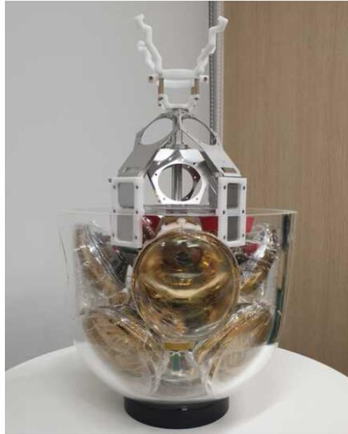
図 3.11: 内部支持構造体 (上半分) と、アセンブリされた PMT モジュール (下半分) [14]
