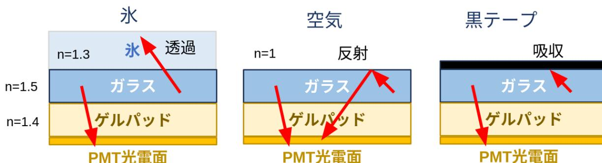
図 5.17: 黒テープと光の反射の関係。南極の氷中では左図のようにガラスと接している氷との屈折率の差は小さいため、多くの光が透過する。一方で実験室では中央図のようにガラスと空気の屈折率の差が大きく、全反射しやすい。そこで右図のようにガラス表面に黒テープを貼り、光子が吸収されるようにすると、PMT 光電面に到達する光子数が氷中と同等になる。
