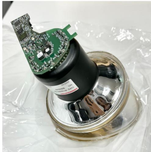
図 3.10: PMT モジュール。これは L3 用のゲルパッドと Equatrical 型の wuBase を取り付けたものである。
