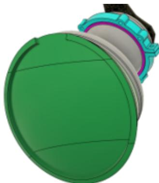
図 4.2: ゲルパッドの CAD 図。円の端にはリムと呼ぶ厚い部分がある。円の上で一部リムが途切れているのは、リム接着後にゲルを流し入れる口となるためである。
