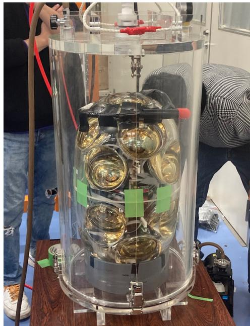
図 4.6: 真空容器を用いた G2DOM の密封作業。真空容器の中に G2DOM を入れ、内部の気圧を変えている。容器の上部には、抜いた空気が通る管と窒素が通る管が付いている。
