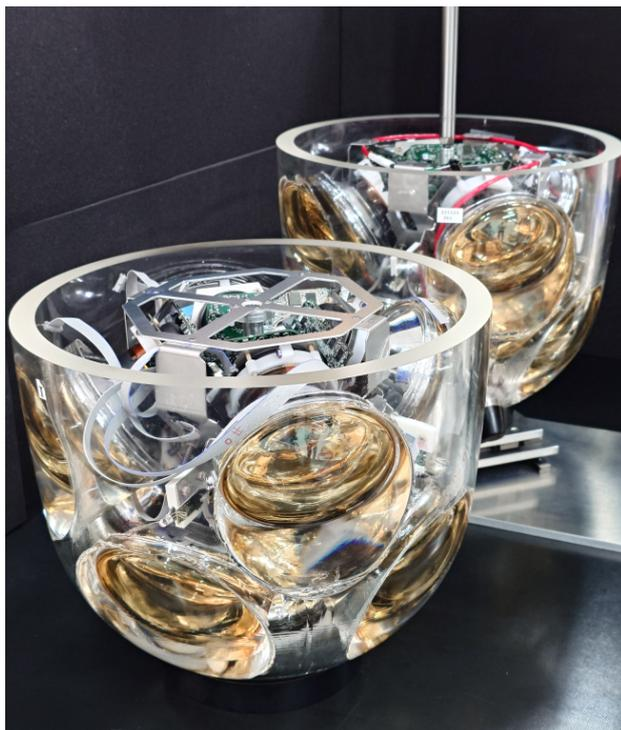
図 4.4: 配線を終えた G2DOM 半球。奥にあるのが上半球、手前にあるのが下半球である。上半球のガラスにはペネトレーターケーブルが付いている。赤いケーブルはペネトレーターケーブルからガラス内部に繋がっている。
