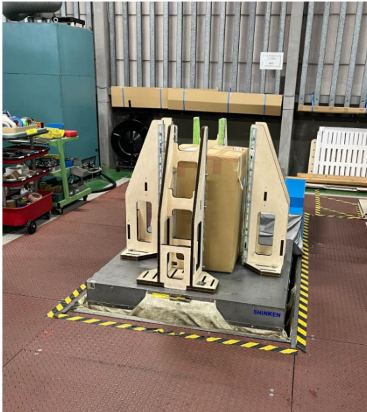
図 A.5: 専用の設備を用いて行った振動試験の様子。神奈川県藤沢市にある日本ビジネスロジスティクス株式会社の包装試験室にて試験を行った。箱が置かれたステージが上下に動く。
