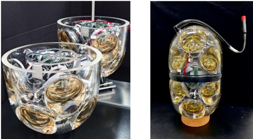
図 6.1: 左図は、アセンブリ後の半球の状態。右図は、密封後の DVT1 が完成した状態。
