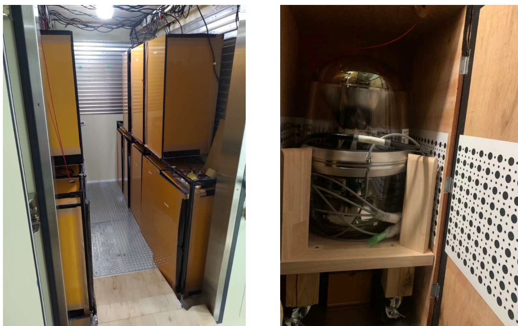
図 3.1: 冷凍庫の内部 (左図) と暗箱内部 (右図)。左図のように冷凍庫内部には暗箱が 16 箱設置されており、同時に 16 個の D-Egg を低温で測定することができる。冷凍庫の天井付近には D-Egg と MFH を接続するためのケーブルと光ファイバーが張り巡らされており、それぞれの暗箱まで伸びている。右図には暗箱内部に設置された D-Egg を示す。暗箱の上面と下面には光ファイバーが取り付けられており、光源を用いた測定を行うことができる。
