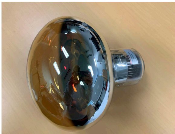
図 2.4: D-Egg に搭載される 8 インチ PMT(浜松ホトニクス製、R5912-100)
