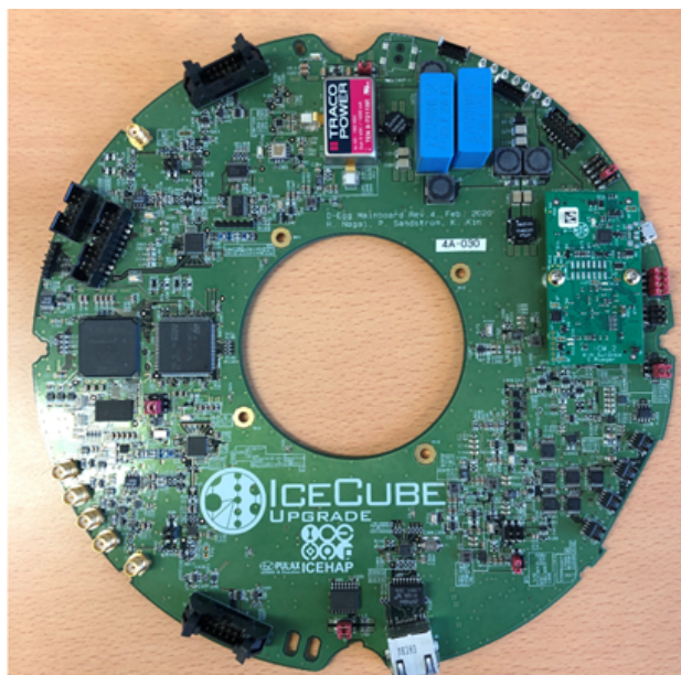
図2.6: D-EggのMain Board。右側にICMが搭載されている。ICMは60 MHzのクロックを搭載しておりICLとのコミュニケーションを行う。
