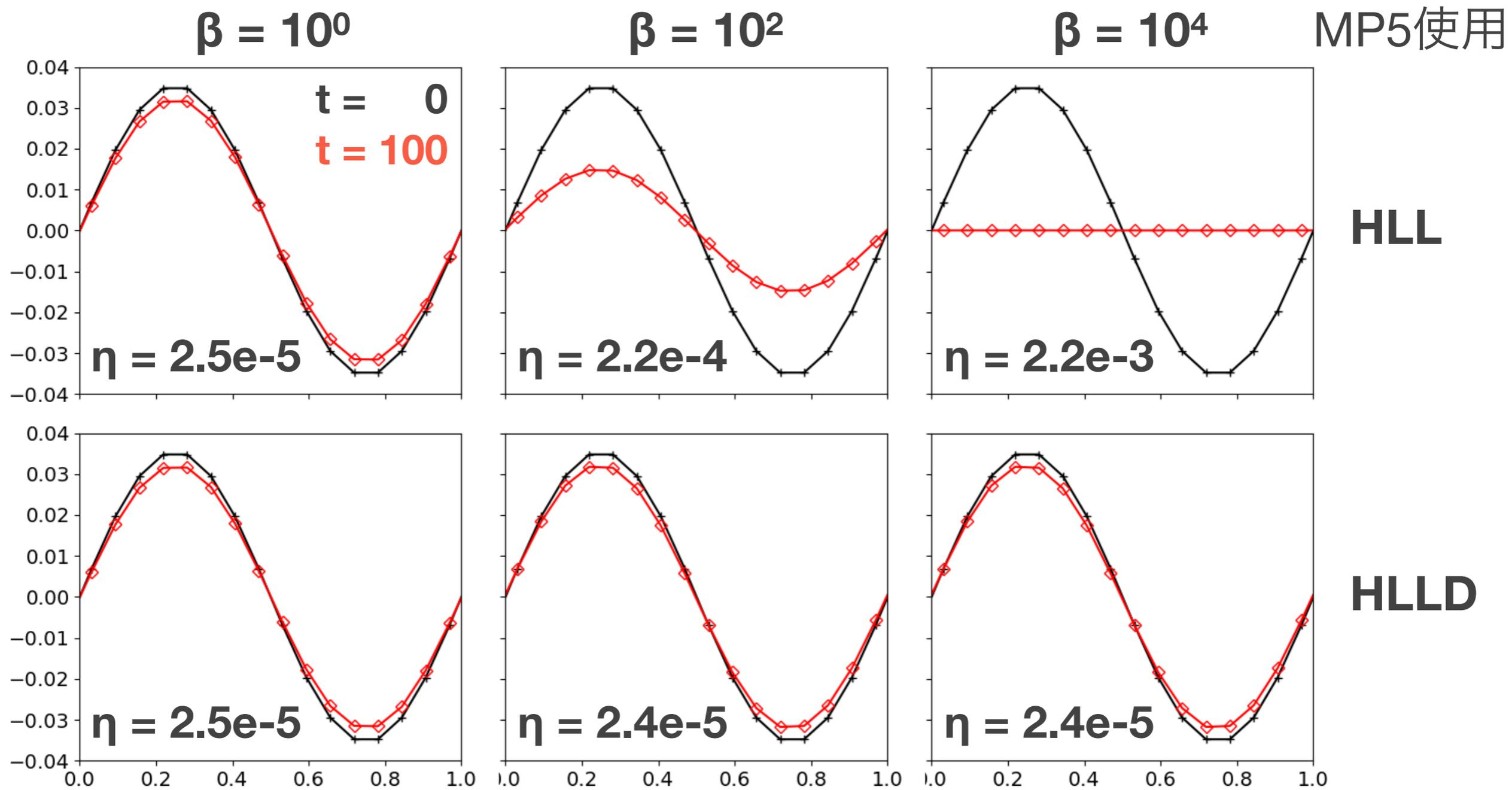
$$\eta_{\text{HLL}} \sim \frac{1}{2} (V_x + c_f) \Delta x \sim \frac{1}{2} c_s \Delta x$$
