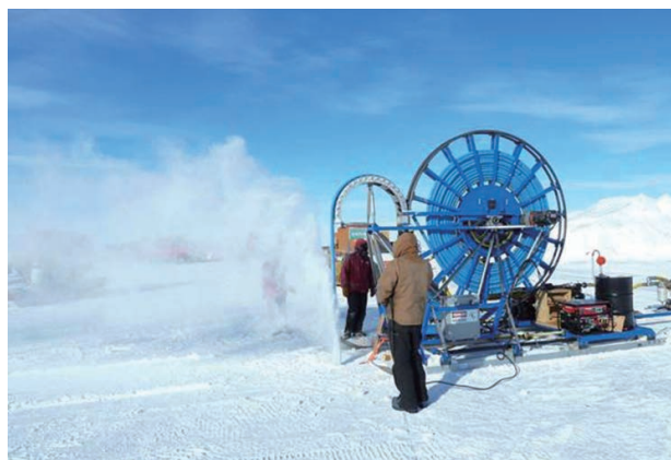
写真2 高速空気流ドリルを用い氷上に穴を開けている様子。
