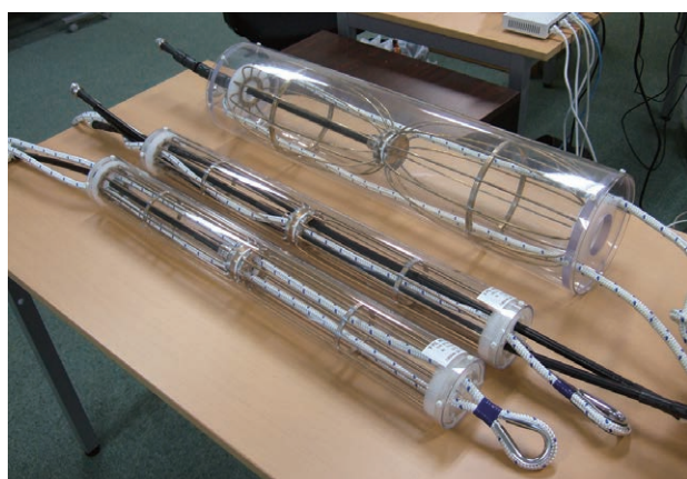
写真1 旧型と新型のARAアンテナ。右上の旧アンテナを改良し、約1/2の幅のスリムな形に。
