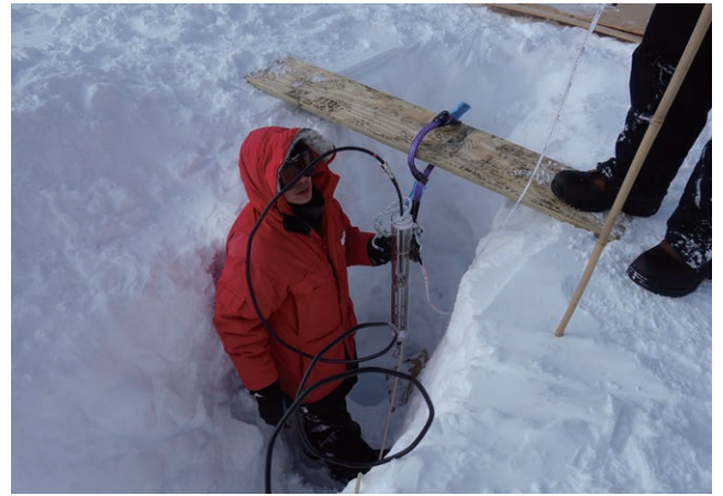
図3: ARA新型細径アンテナの南極での実地試験の様子。約1.5mもの雪かき後に以前に開けられたRAM掘削機による穴を発見。
