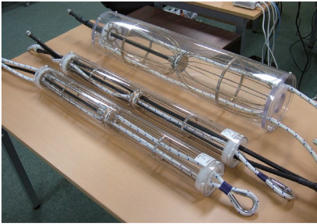
図2: ARAオリジナルアンテナ(右上)と千葉大学で新たに開発した細型アンテナ(左下、古河C&B製作)
